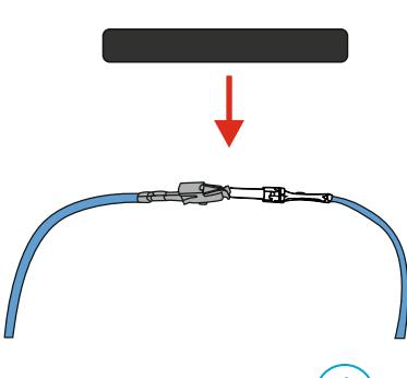
1. Возьмите из комплекта термоусадочную трубку и установите ее на замкнутые контакты «мама», «папа».
