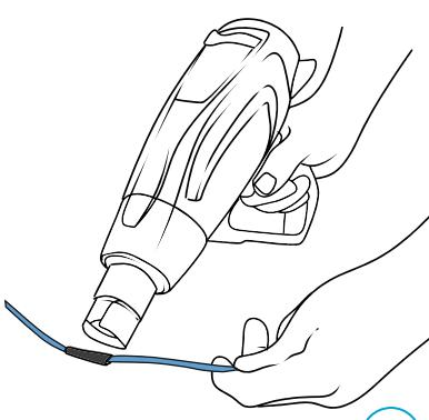
1. С помощью строительного фена нагревайте термоусадочную трубку.
